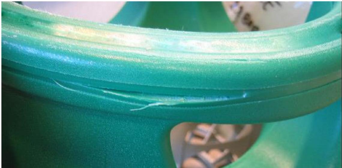
**Figures 2 et 3:** Dommages à l'enveloppe extérieure - inacceptable
