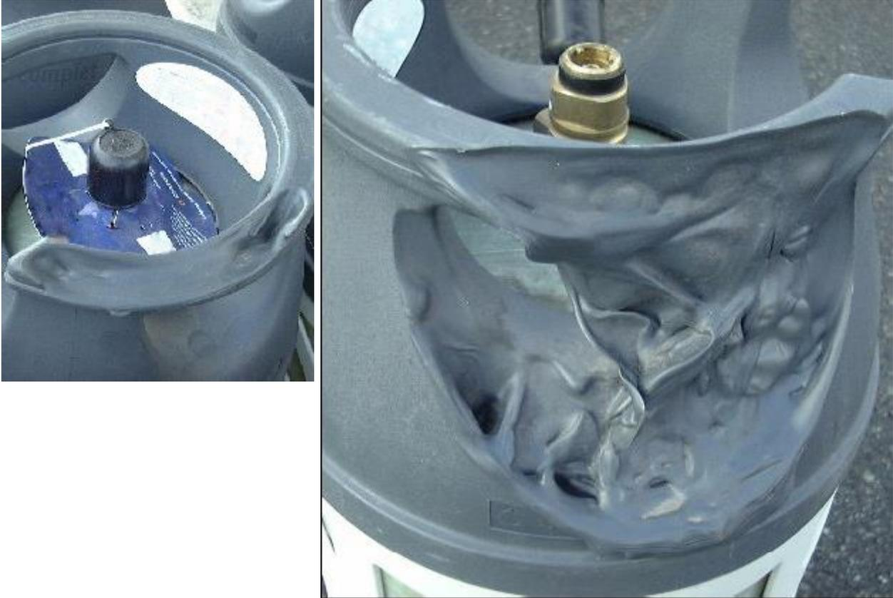
**Figures 5 et 6 : Dommages à l'enveloppe extérieure causée par la chaleur – inacceptable**
